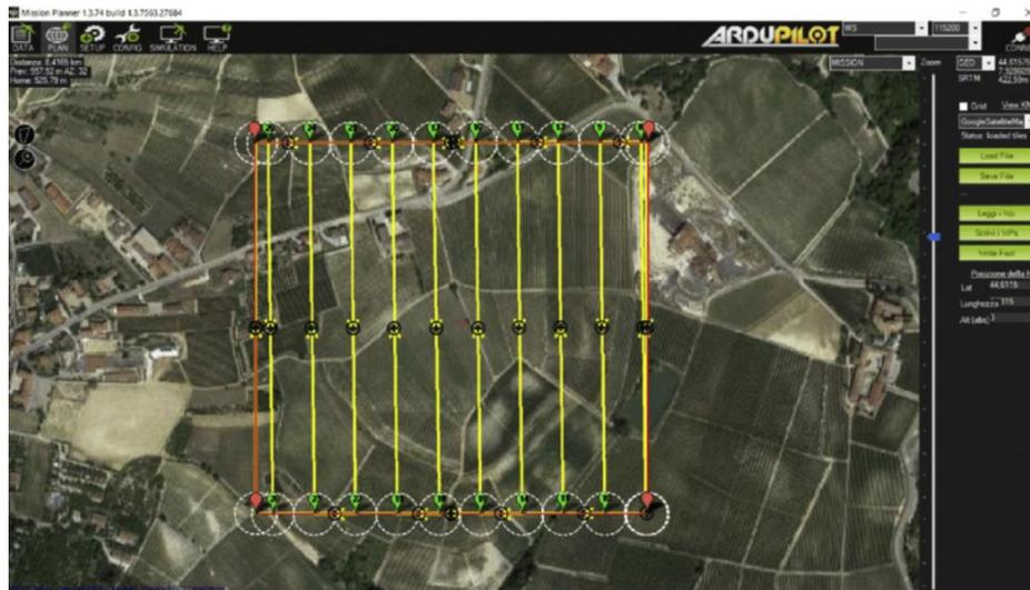
Figure 38 : Exemple d'emploi de l'outil de cadrillage natif de MissionPlanner
