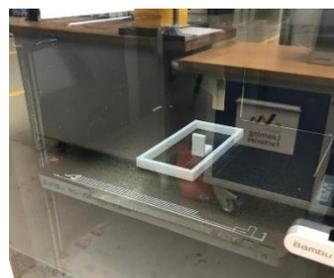
Figure 15 : Impression du cadre et de l'équerre test sur l'imprimante Bambu Lab
