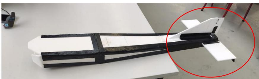
Figure 17 : Empennage fixé au fuselage
