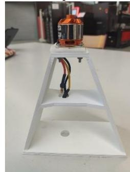
Figure 24: Fixation du moteur sur le nez
