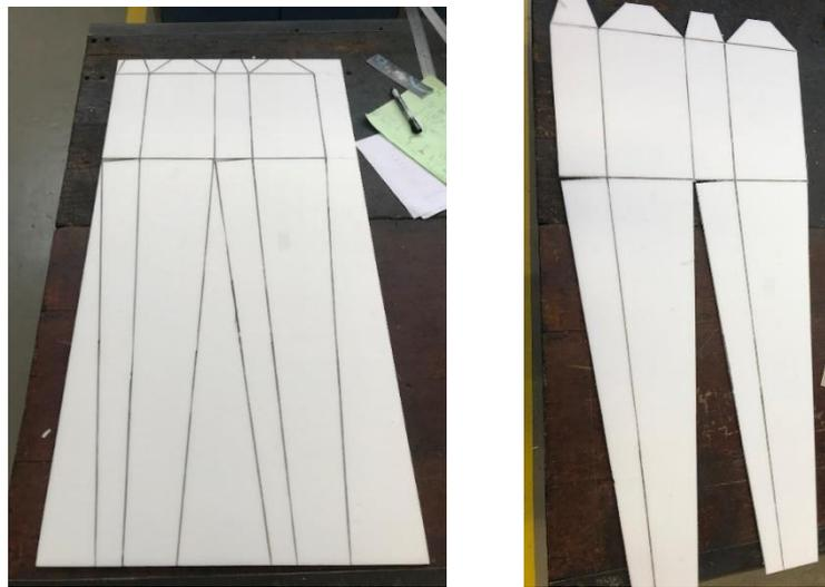
Figure 13: Forme du fuselage avant (gauche) et après(droite) découpe
