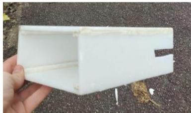
Figure 14: Prototype de fuselage, rigidifié par des languettes de Depron aux quatre coins
