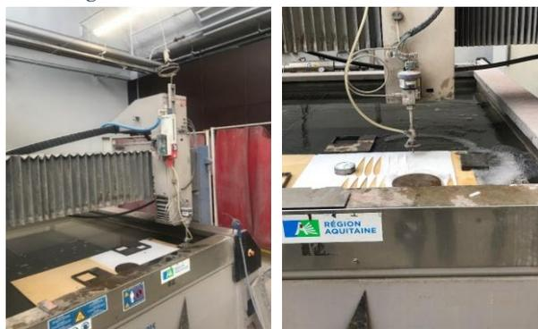
Figure 9 : Découpe des nervures au jet d'eau
