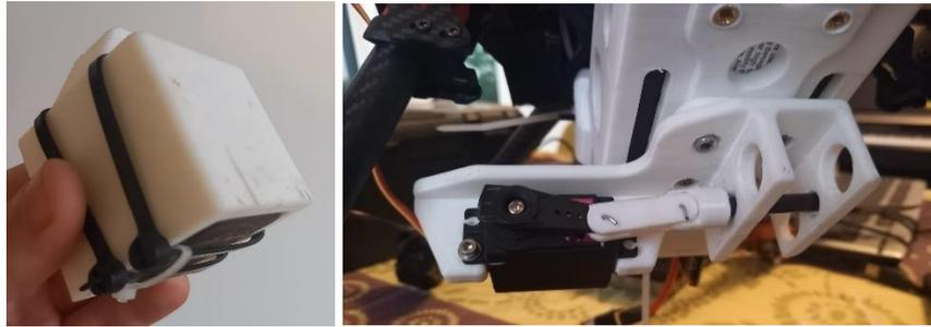
Figure 35: Masse largable et système de largage complet
