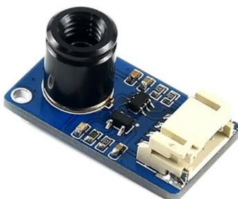
Figure 29 : Caméra thermique MLX 9064X
