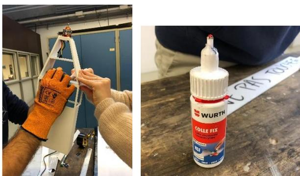
Figure 26: Collage du nez au renfort de fuselage (à gauche) et colle utilisée (à droite)
